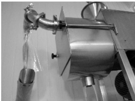
Figura 3: Separador rotativo de polpa e sementes. Saída de sementes (superior esquerdo) e polpa (inferior)
