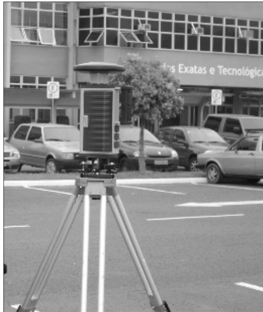
**Figura 5:** GPS Geodésico – Ashtech Z-Max.
