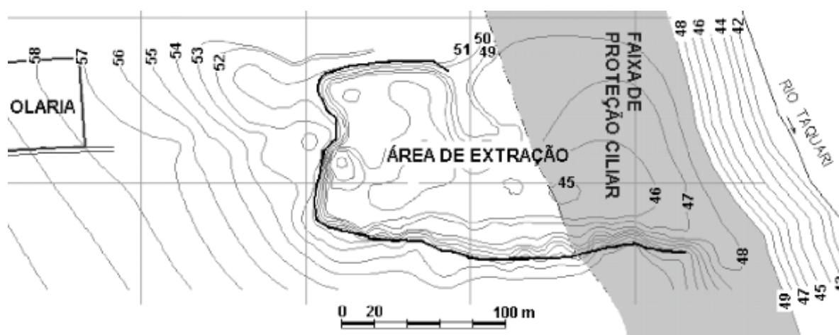
Figura 4 APP definida a partir da cota obtida pela média das cheias máximas anuais.
