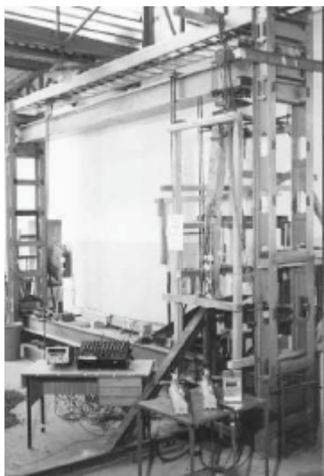
Figura 18 Pórtico de carga.
