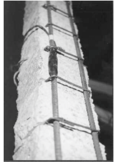
Figura 15 Instrumentação das barras de armadura longitudinal.
