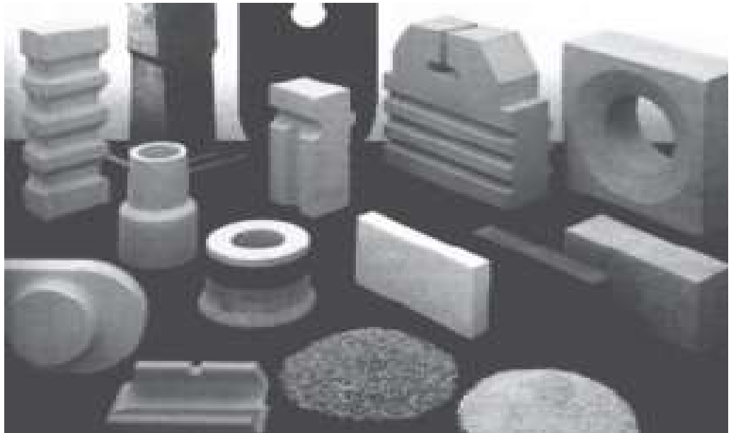
Foto 3 - Materiais cerâmicos utilizando resíduos de couro (serragem de couro) Fonte: Laboratório de Materiais Cerâmicos.- Escola de Engenharia, UFRGS.
