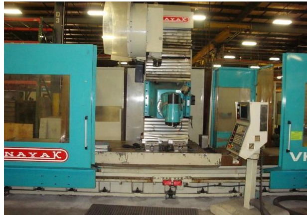
Figura 7 - Centro de usinagem vertical Anayak 3000 Fonte: Dado da empresa
