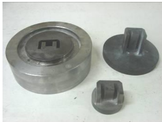
Figura 3 – Amostras na forma de núcleo de transformador – (a) Matriz Núcleo E Fonte: do Autor
