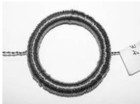
Figura 4 – Etapas de preparação das amostras: (d) enrolamento do primário Fonte: do Autor
