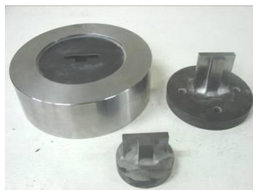
Figura 3 – Amostras na forma de núcleo de transformador– (b) Matriz Núcleo Fonte: do Autor
