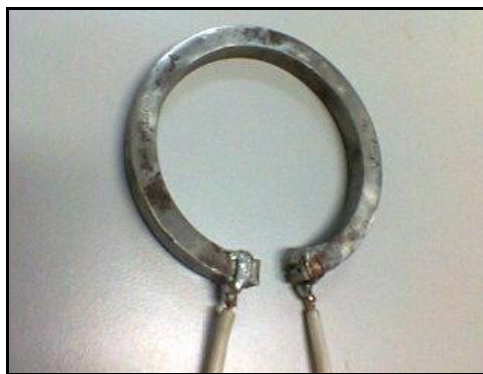
Figura 5 – Anel segmentado com terminais para medida da resistividade elétrica Fonte: do Autor
