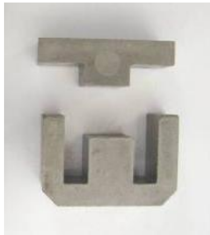
Figura 3 – Amostras na forma de núcleo de transformador – (c) Corpos de Prova Fonte: do Autor
