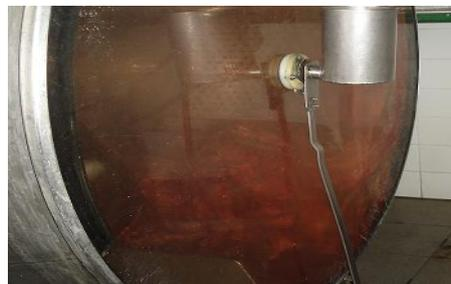
**Figura 1: Operação de remolho da pele verde**
