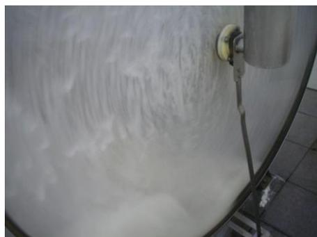
Figura 5: Processo de desencalagem e purga
