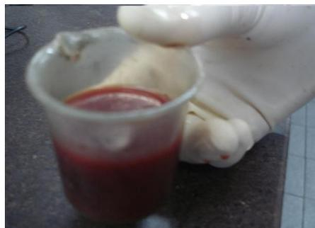
Figura 3: Banho residual de remolho da pele verde
