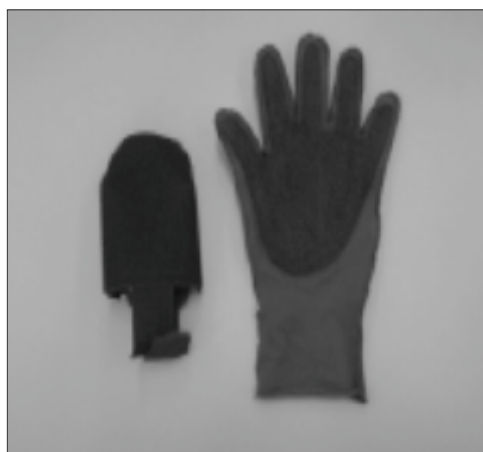
Figura 3: Acoplador de mouse e luva contenedora.
