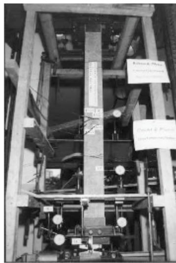
Figura 19 Posicionamento dos deflectômetros.
