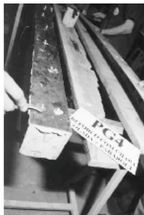
Figura 8 Aperto dos parafusos e eliminação do excesso de resina.
