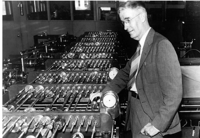
Figura 2 - O primeiro computador analógico em grande escala o “analisador diferencial” inventado e construído por Vannevar Bush na década de 1930 (FLORESS, 2010) Fonte: http://www.computerhistory.org/revolution/analog-computers/3/143/312
