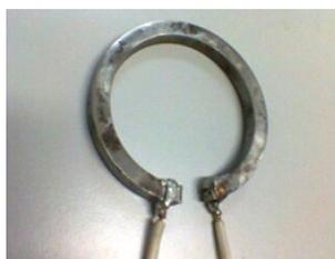
Figura 5 – Anel segmentado com terminais para medida da resistividade elétrica.
